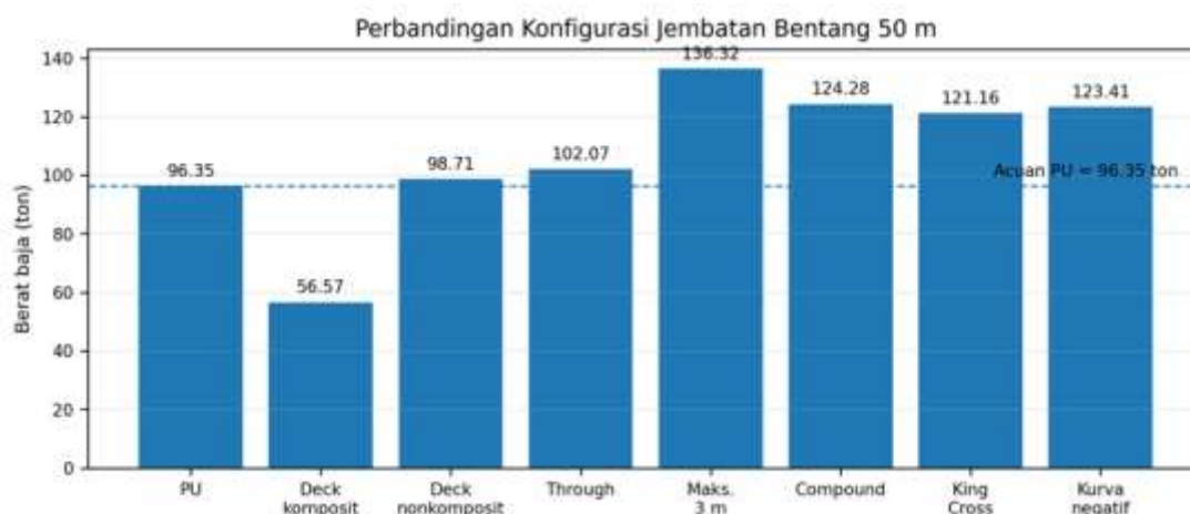
Gambar 5. Berat berbagai konfigurasi jembatan bentang 50 m Sumber: data penelitian, 2026.
