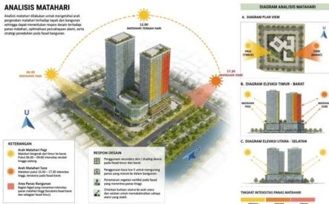
Gambar 3. Diagram Analisis Pergerakan Matahari dan Respon Desain Bangunan Sumber: Analisis Penulis berdasarkan GBCI (2021) dan Survey Lapangan, 2026
