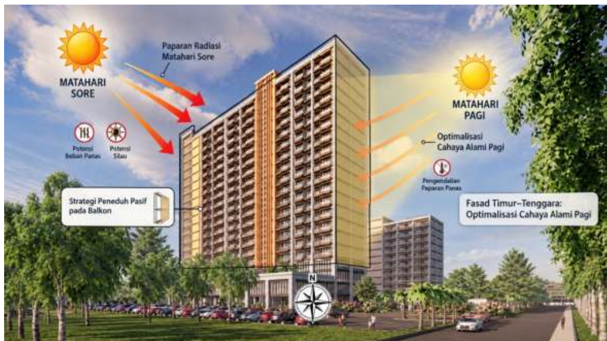
Gambar 5. Penerapan hasil analisis orientasi matahari pada konfigurasi dan respons fasad bangunan.
