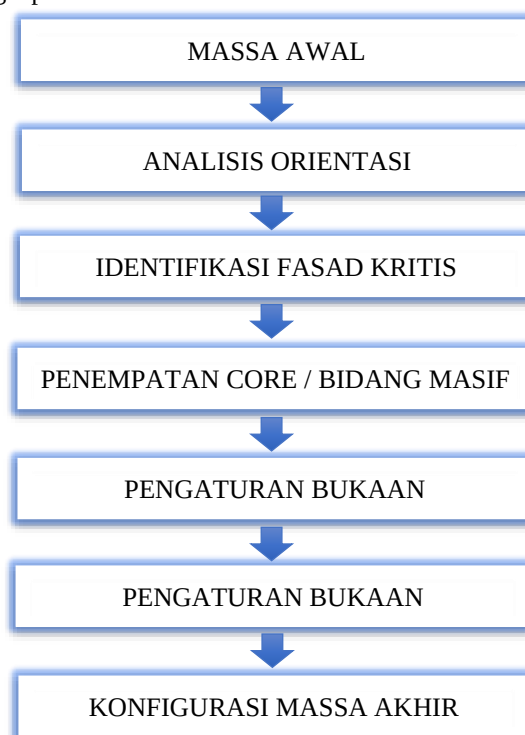
Skema 2. Transformasi hasil analisis matahari menjadi orientasi dan konfigurasi massa bangunan. Sumber: Hasil analisis dan perancangan Penulis, 2026.
